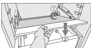
7. Otočte poličku naopak a vložte ju naspäť. Uistite sa, že správne zapadla do drážok na zadnej stene spotrebiča (šípka 1). Potom ju opatrne položte späť nad zásuvku na ovocie a zeleninu tak, ako to zobrazuje šípka 2.
