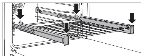
Zaťažiteľnosť FlexiClip plnovýsuvných pojazdov je maximálne 15 kg.
