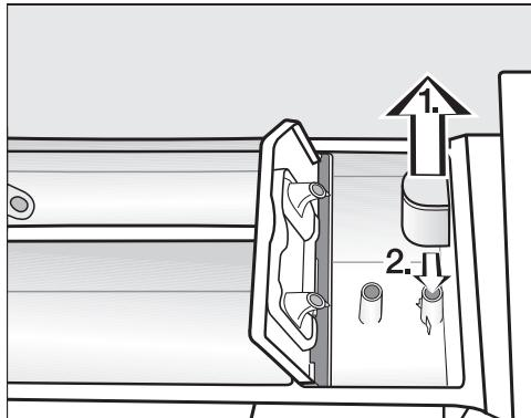
1. Vytiahnite násosku z komory ☘ a vyčistite ju pod tečúcou teplou vodou. Vyčistite aj rúrku, na ktorú sa násoska nasadzuje.
