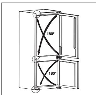
5. Upevnite spodný záves pomocou skrutiek a nasadte spodné dvierka na čap spodného závesu a držte ich v danej polohe. Upravte stredné pánty tak, aby boli dvierka správne vyrovnané, a potom ich upevnite a uistite sa, že sú spodné dvierka zaistené na svojom mieste.
