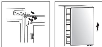
3. Uvoľnite skrutky slúžiace na upevnenie stredných dverných závesov a vyberte ich. Potom vyberte spodné dvere. A odskrutkujte spodný záves dveriek.
