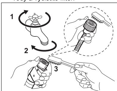
2. Prívodnú hadicu odpojíte od spotrebiča uvoľnením kruhovej matice.
