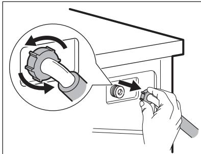
3. Kefkou na zuby vycistite filter ventilu na zadnej strane spotrebiča.
