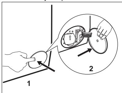
2. Pod vývod vypúšťacieho čerpadla položte vhodnú misku, aby ste zachytili vytekajúcu vodu.
