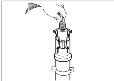
5. **Bez plastového držiaka hadice, do sifónu umývadla** – Odtokovú hadicu pripojte k prípojke sifónu a utiahnite svorkou. Pozrite si príslušný obrázok.
