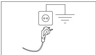
Prívodný elektrický kábel musí byť ľahko prístupný aj po inštalácii spotrebiča.
